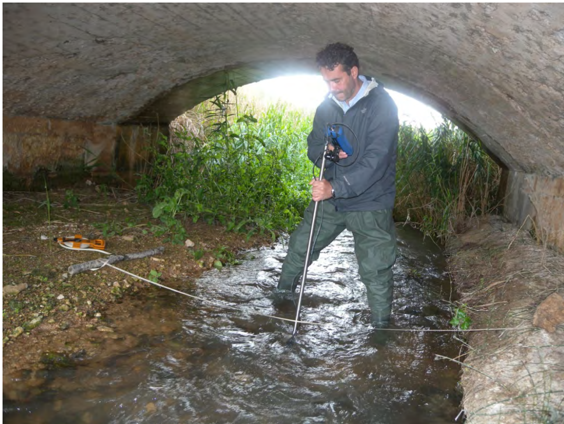
Figura nº 12. Aforo mediante medidor de flujo magnético OTT en el río Badiel en Utande (21198TBB).
